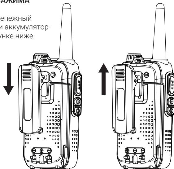
**Примечание:** Не используйте какой-либо клей для фиксации винта на крепежном зажиме. Клей с растворителем может повредить корпус аккумулятора.
