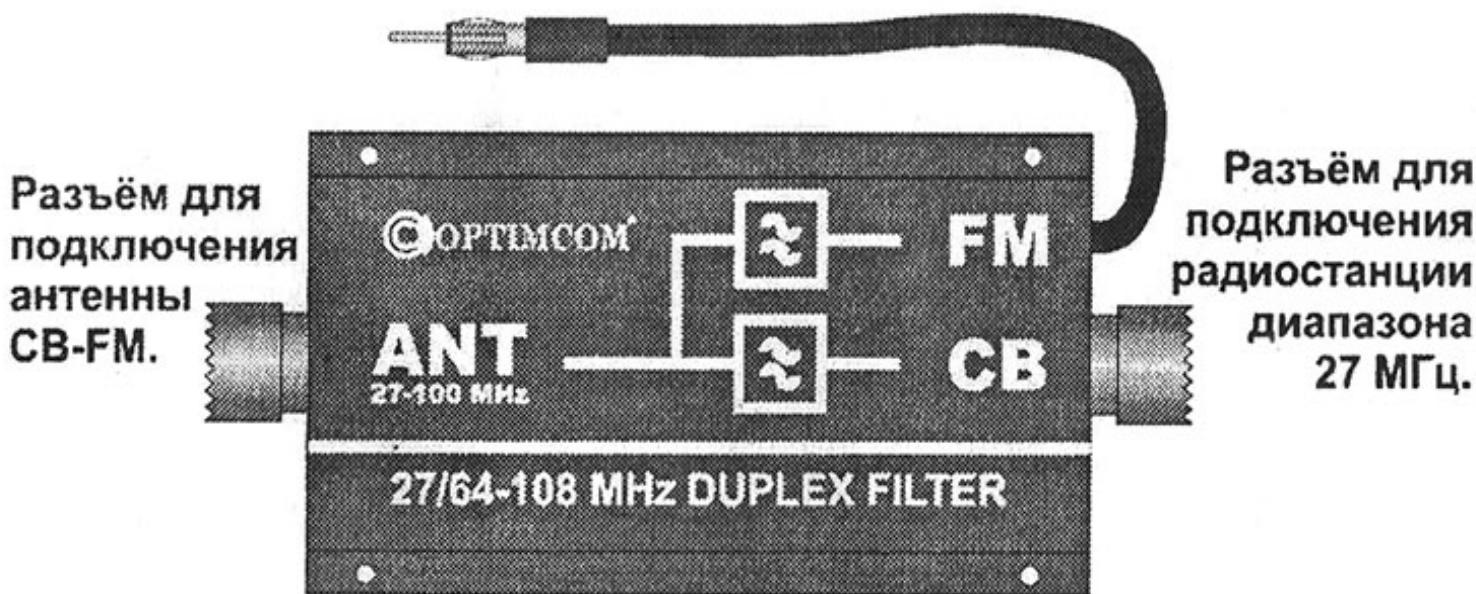
Обращаем ваше внимание на то, что использование кабеля для подключения радиостанции длиной более 0,5 м нежелательно, и может привести к ухудшению согласования антенны.
